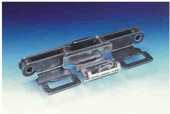
Vertikal umlaufende Gleitkette in Ausführung als Nadelkette mit Abnadelerschutz geschlossen, Gleitbahn und -bolzen sind geschmiert (Brückner Trockentechnik GmbH & Co KG, D-Leonberg)
