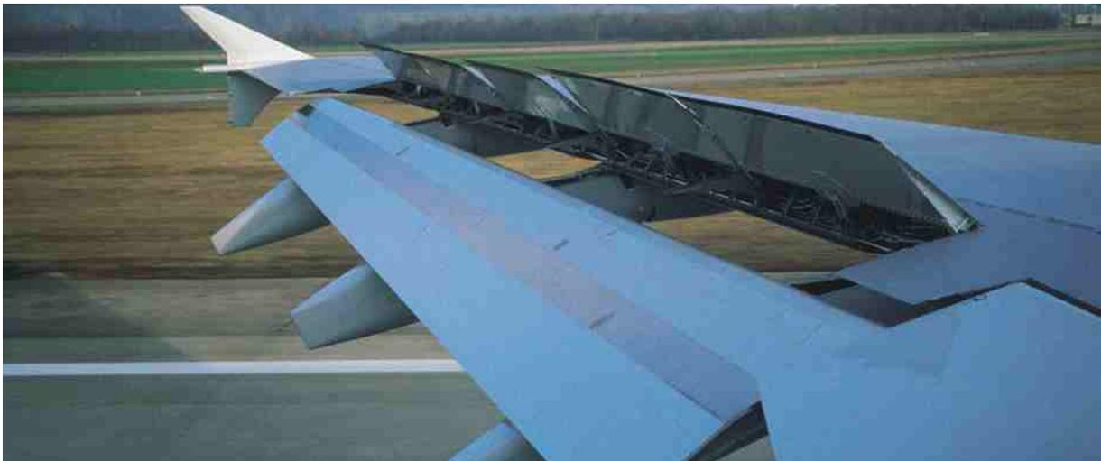
Landeklappenbetätigungssystem des Langstrecken-Airbus A 330/A 340
