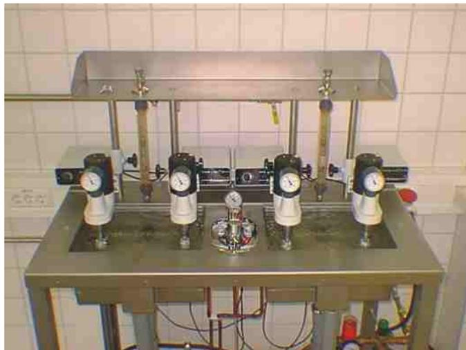
WRT-Prüfmaschine für Armaturen (Archiv)
