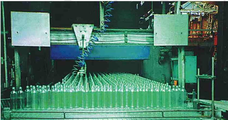
IS-Maschine Formgebung (P-D Glas- und Feuerfestwerke Wetro GmbH, D-Freital)
